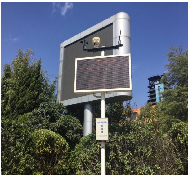
公司内部噪声实时监控设备
